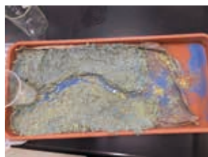
図6 簡易流水実験装置
